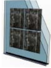
Laminar FV + cámara + templado 5 + 1,5 + 5 / 12 / 5 mm. *e. cámara variable
