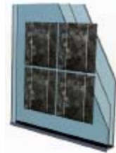
Laminar FV + cámara + laminar 5 + 1,5 + 5 / 12 / 4 + 4 mm. *e. cámara variable
